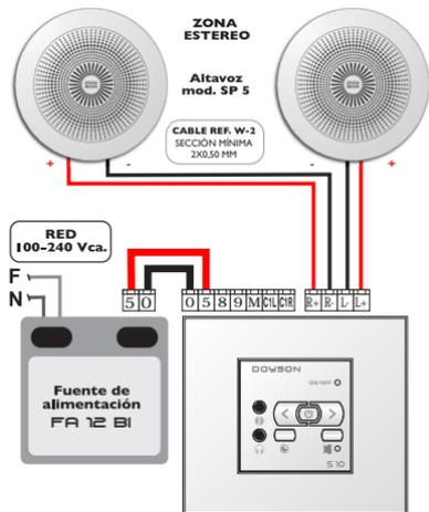
**Para CONEXIÓN AUXILIAR de audio, TV, PC, etc. utilizar 0 (masa), C I L y C I R (canales I izq. y derecho)**
