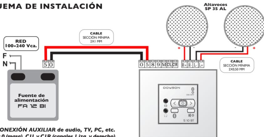
Para **CONEXIÓN AUXILIAR** de audio, TV, PC, etc. utilizar **0 (masa), CIL y CIR (canales I izq. y derecho)**
