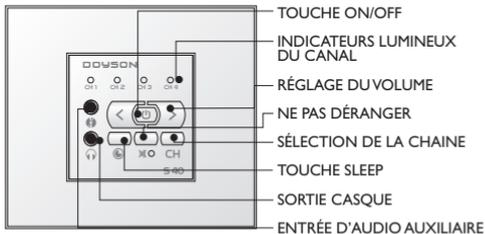
**PALLUMAGE / EXTINCTION DE LA TELECOMMANDE :** Pressez la touche ON/OFF pour allumer. La Led de la dernière chaîne écoutée s'allume et indique ainsi son activation. Pour éteindre la télécommande, appuyer à nouveau sur la même touche ON/OFF.
