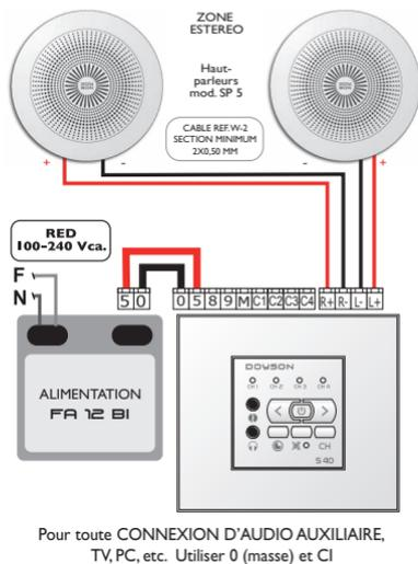
Remarques : l'unité centrale UC 400 S supporte un maximum de 10 télécommandes et une distance maximum de câble de 100 m. pour le point le plus éloigné. Pour toute installation plus grande, il faudra ajouter une alimentation ou une unité centrale plus puissante. Relier la borne « M » en cas d'installation mixte comportant des télécommandes à microphone ou des pupitres CN-500.
