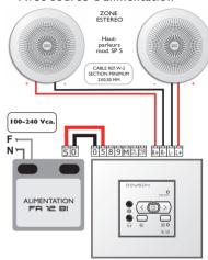
Pour toute CONNEXION D'AUDIO AUXILIAIRE, TV, PC, etc. Utiliser 0 (masse), CIL et CIR (canaux I gauche et droit)
