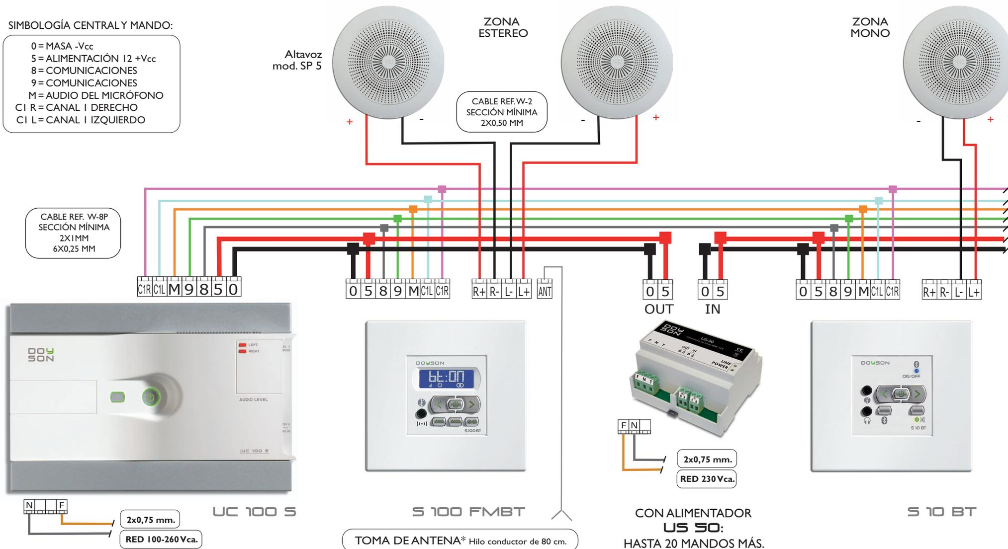
Observaciones: La Unidad Central UC-100S soporta un max. de 10 mandos, y una distancia max. hasta el último elemento a controlar de 100 m. de cable. Para instalaciones superiores, habría que añadir alimentadores o una UC de más potencia. \*Se recomienda en zonas de mala recepción toma de antena exterior.
