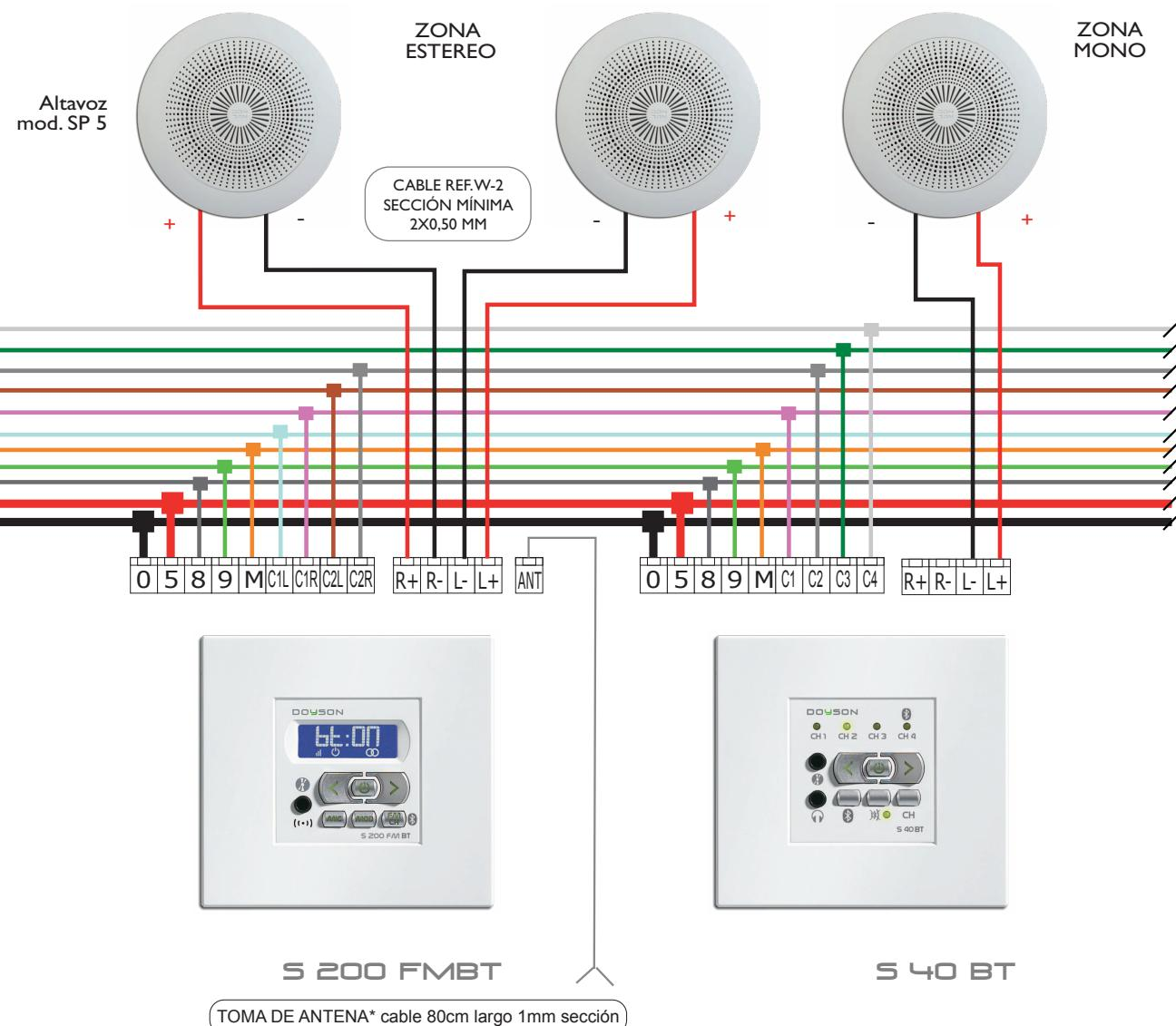
Observaciones: La Unidad Central UC-400S soporta un max. de 10 mandos, y una distancia max. hasta el último elemento a controlar de 100 m. de cable. Para instalaciones superiores, habría que añadir alimentadores o una UC de más potencia. \*Se recomienda en zonas de mala recepción toma de antena exterior.
