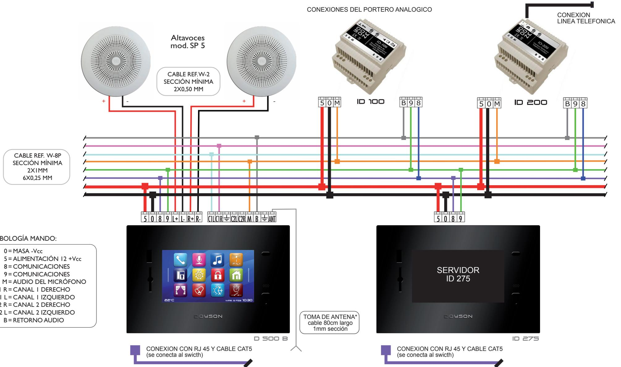
Observaciones: \*Se recomienda en zonas de mala recepción toma de antena exterior. Para conexión de línea telefónica con ADSL, hay que conectarle un filtro. La tarjeta de portero ID-100 es compatible con porteros analógicos de 5 hilos. Para porteros digitales consultar fábrica.
