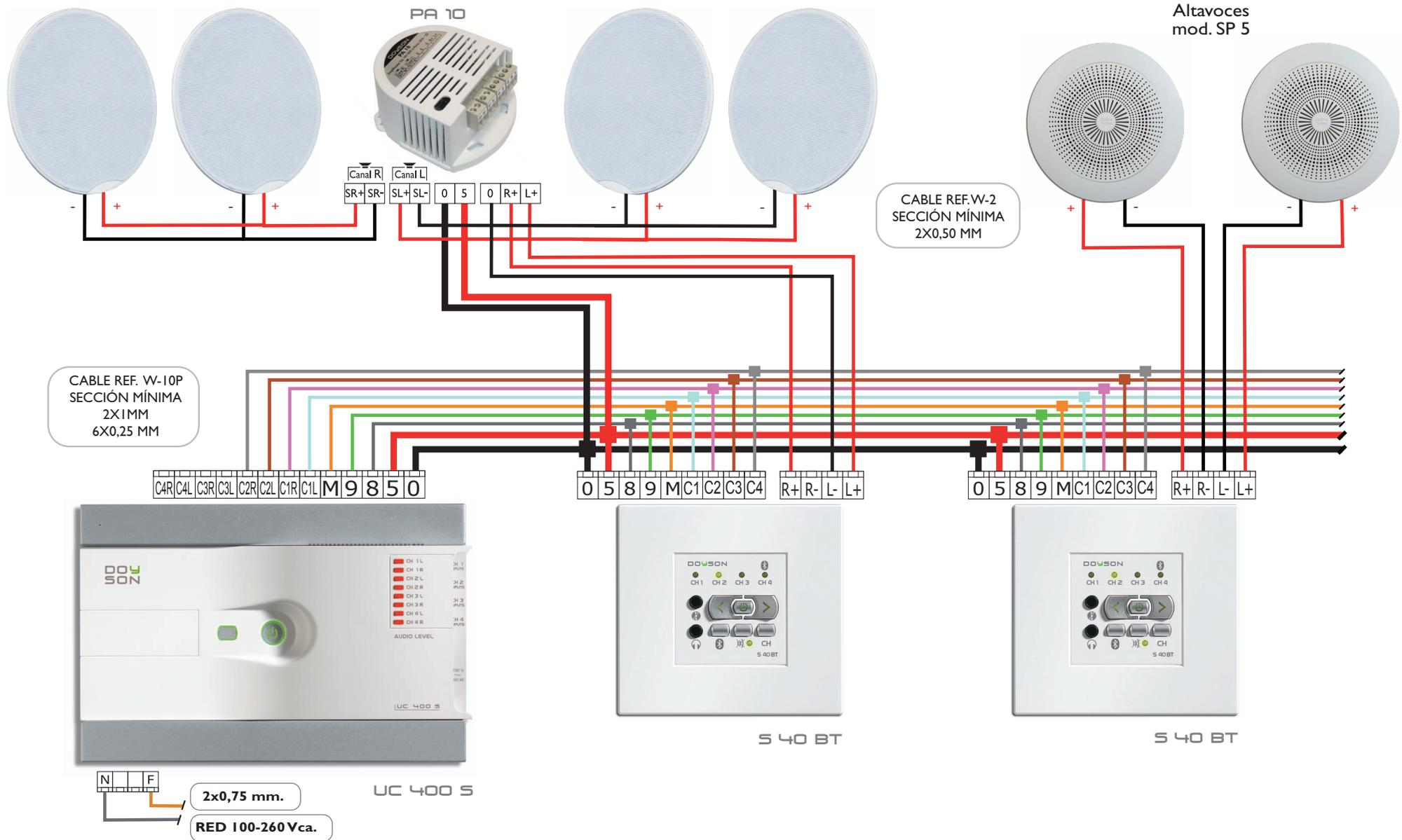
Observaciones: La Unidad Central UC-400S soporta un max. de 10 mandos, y una distancia max. hasta el último elemento a controlar de 100 m. de cable. Para instalaciones superiores, habría que añadir alimentadores o una UC de más potencia. \*Se recomienda en zonas de mala recepción toma de antena exterior.
