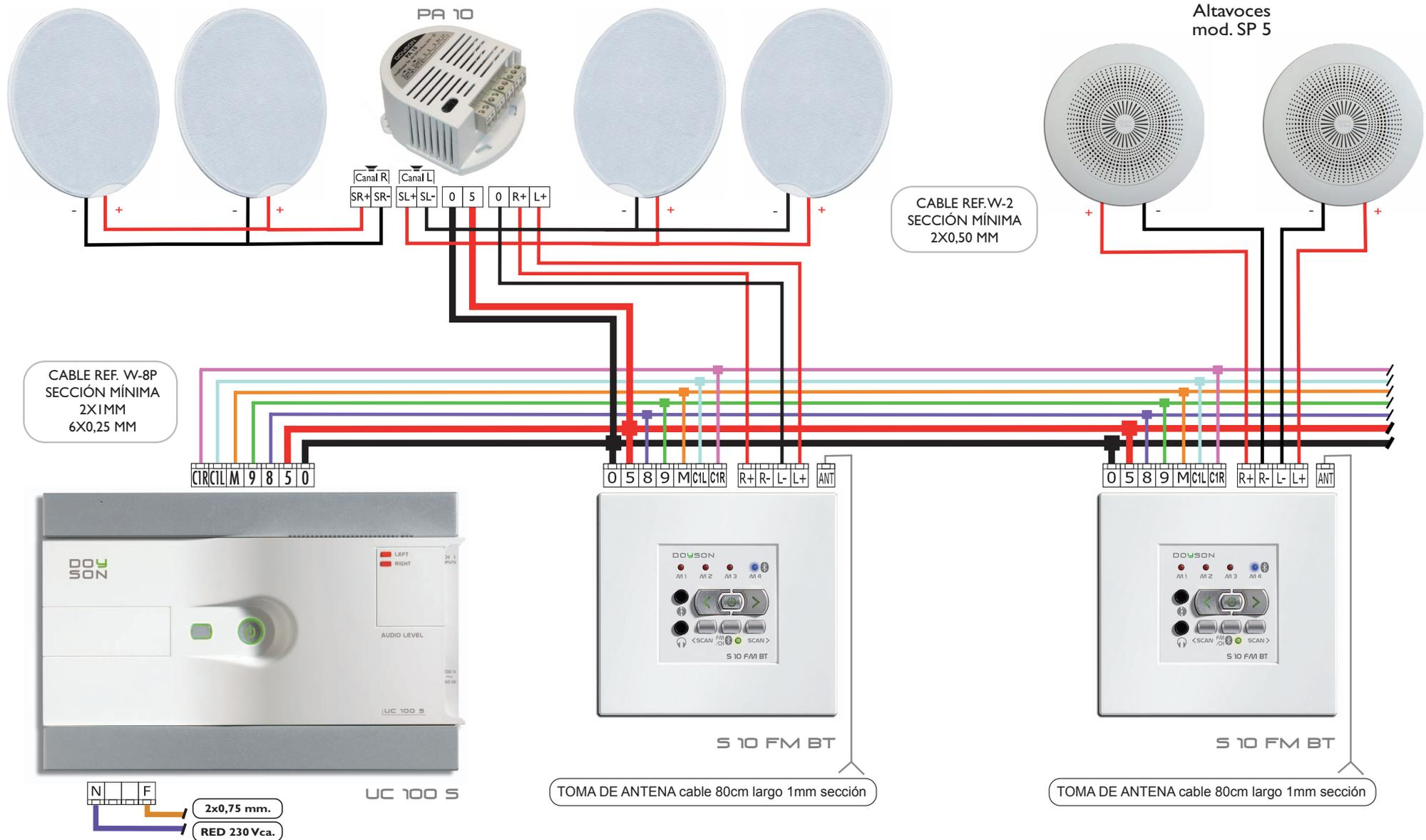
Observaciones: La Unidad Central UC-100S soporta un max. de 10 mandos, y una distancia max. hasta el último elemento a controlar de 100 m. de cable. Para instalaciones superiores, habría que añadir alimentadores o una UC de más potencia. \*Se recomienda en zonas de mala recepción toma de antena exterior.
