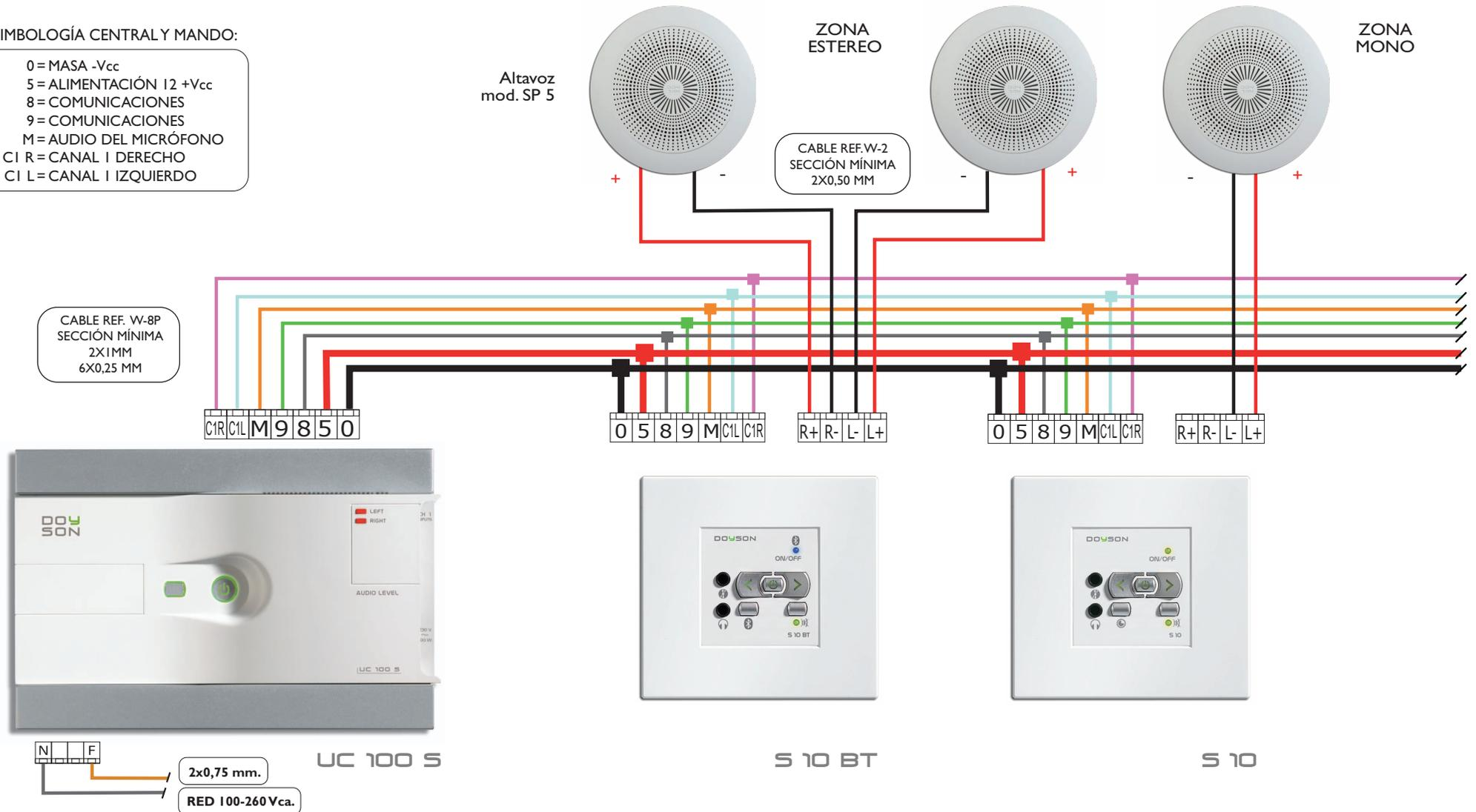
Observaciones: La Unidad Central UC-100S soporta un max. de 10 mandos, y una distancia max. hasta el último elemento a controlar de 100 m. de cable. Para instalaciones superiores, habría que añadir alimentadores o una UC de más potencia.
