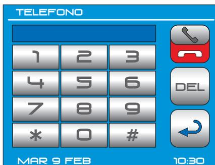
**Para realizar llamadas** marque el número mediante el teclado numérico y a continuación pulse el icono cambiará a y el teclado desaparece. Mediante las teclas VOL- y VOL+ puede modificar el volumen de recepción de la llamada en curso. Para finalizar la llamada pulse de nuevo el icono .
