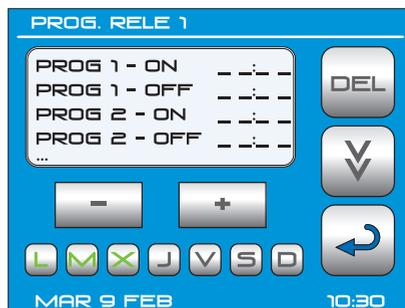
Primero pulse el icono para acceder a la pantalla de programación, en la ventana muestra la lista de hasta 10 programaciones con posición de encendido (ON) y apagado (OFF). Mediante el icono recorra los programas, situese en PROG1-ON y con los iconos - y + elija la hora de inicio, luego elija la hora de apagado en PROG1-OFF. En la parte inferior elija el día o días para la programación semanal.
