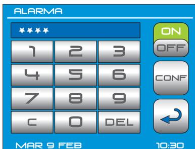
Para **ACTIVAR** la alarma pulse el icono que cambiará a mostrando en la ventana la cuenta atrás del TIEMPO DE SALIDA, acompañado de señal acústica (pitido largo). Transcurrido el tiempo de salida, mostrará el mensaje “ARMADA” y la pantalla atenuará su iluminación al mínimo.
