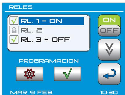
Dispone de hasta 3 RELÉS para conectar sistemas de riego, iluminación exterior, etc.
